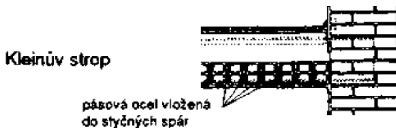
Obr. 6.: Kleinův strop
